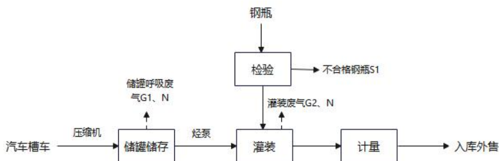
图 2-2.2 项目卸车、灌装工艺流程及产污环节图
