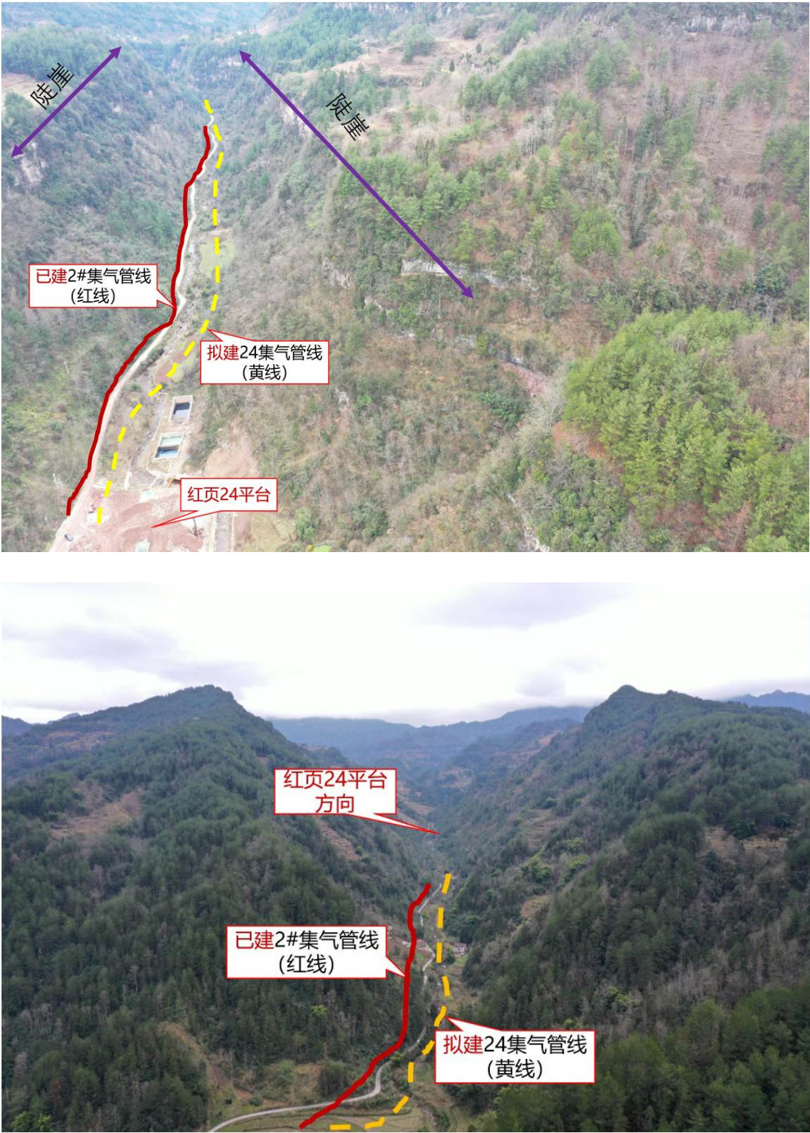
图 2.5-3 管线敷设走向与地势关系图
