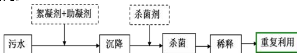
图 5.1-2 污水重复利用处理工艺流程
