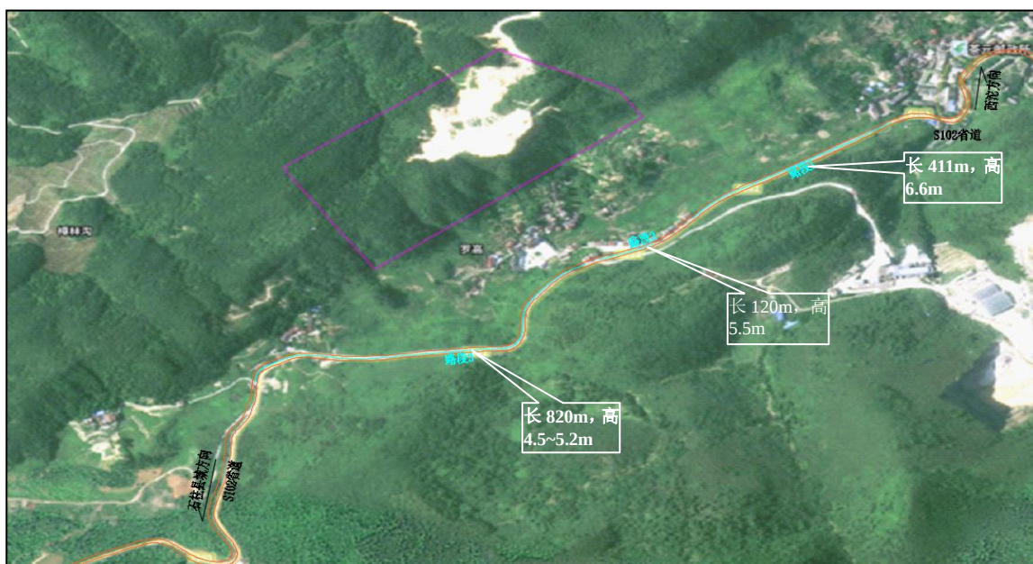
图 4.2-13 道路视觉遮挡屏障设立位置示意图
