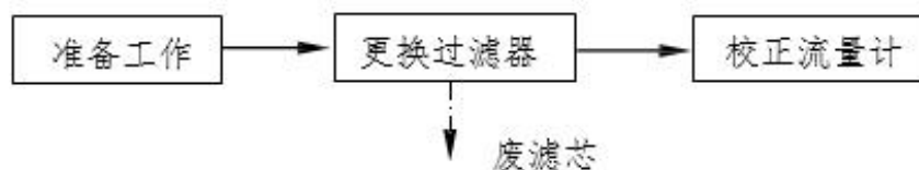
图 2.4-5 加油机检修工艺流程及排污节点图
