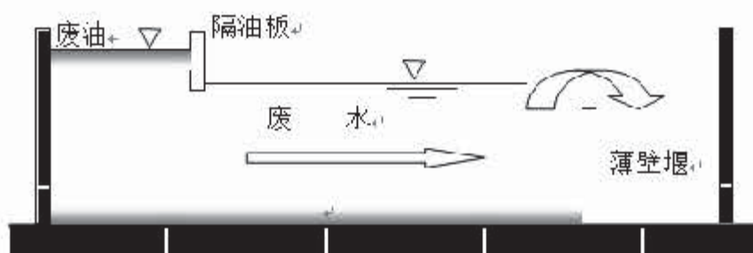
图 7.1-3 小型隔油沉淀池示意图
