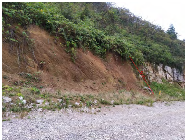
图 3-11 马湖池横梁子逆断层剖面
