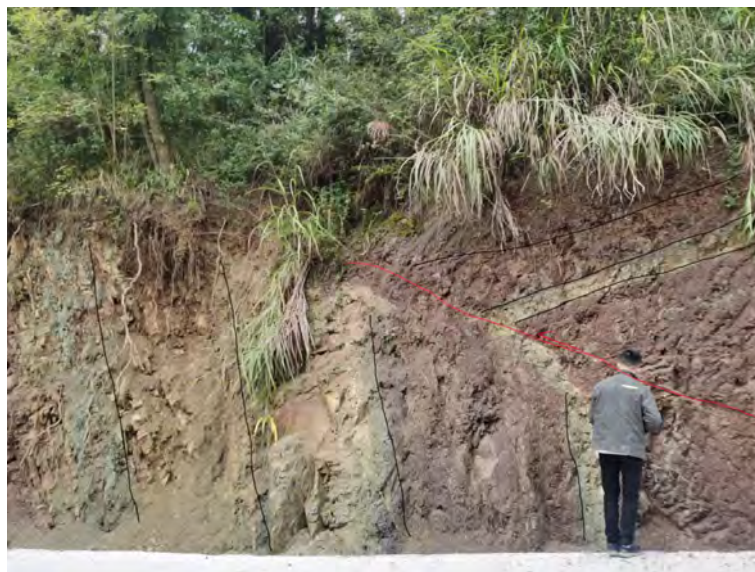
图 3-7 吊钟坝逆断层典型断层剖面
