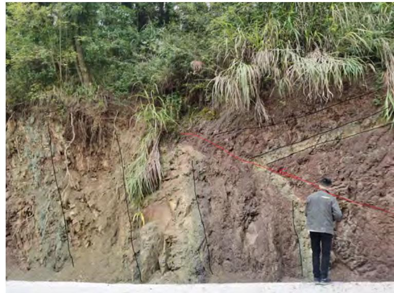
图 3-7 吊钟坝逆断层典型断层剖面
