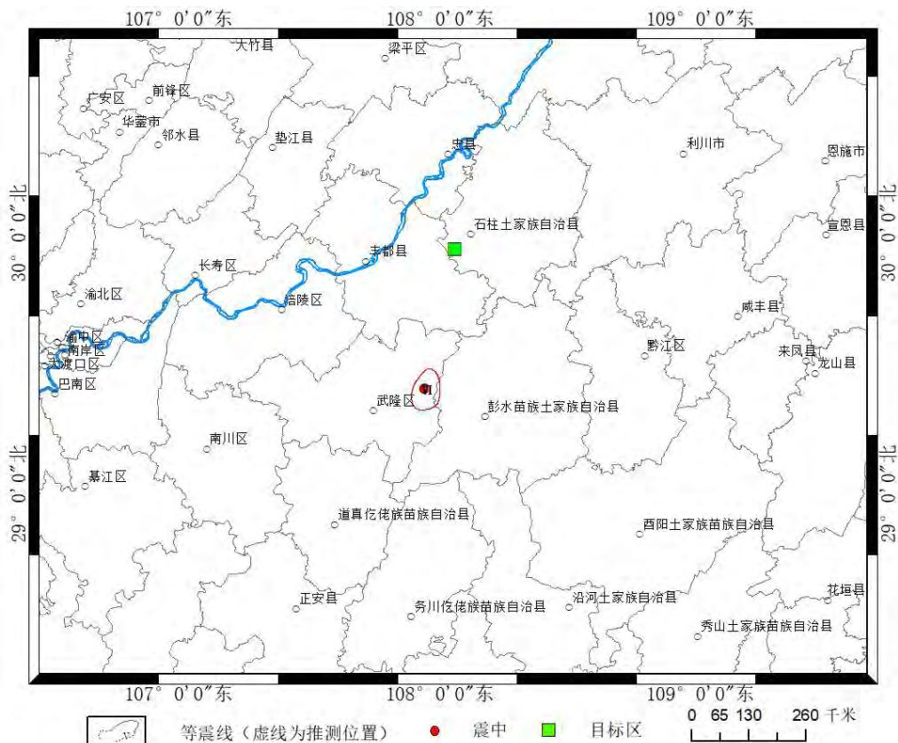
图 1-17 武隆 5.0 级地震烈度分布图 (重庆市地震局)
